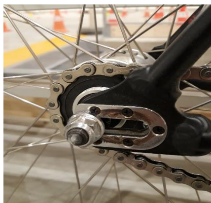
Hátsótengely rögzítés, fix egysebességes fogaskerék, hátra felé nyitott papuccsal
